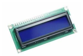
LCD 12C (*Liquid Crystal Display*) yang sudah terdapat rangkaian PCB untuk menghubungkan ke komponen lain, berfungsi untuk media menampilkan karakter angka ataupun gambar yang telah diprogram.
