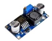
Power LM2596 gunakan untuk system control seperti Arduino dan ATMEGA atau mikrokontroler lain. Power LM 2596S ini untuk power supply switching dan beban ARUS yang lebih tinggi.
