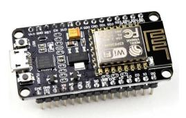
NodeMCU merupakan alat open source platform IoT dan pengembangan kit yang menggunakan bahasa pemrograman untuk membantu dalam pembuatan prototype produk IoT atau bisa dengan memakai sketch dengan Arduino IDE. Pengembangan kit ini didasarkan pada modul ESP8266, yang mengintegrasikan GPIO, PWM(*Pulse Width Modulation*), IIC, 1-Wire, dan ADC (*Analog to Digital Converter*) semua dalam satu board.
