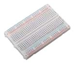
*Project Board* atau yang sering disebut sebagai Breadboard adalah dasar konstruksi sebuah rangkaian elektronik, untuk merangkai komponen agar bisa menjadi rangkaian yang sempurna.
